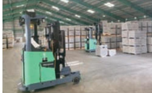
今年度は白河工場にて製品の無人搬送リフト（AGF）の導入を行いました。広い製品倉庫内に常時4台のAGFを走らせ、でき上がった製品の搬送や倉庫倉入れ作業及び翌日以降の出荷製品倉出し作業までを自動で行います。また、製品倉庫内の在庫状況管理や製品倉入れ・倉出しの指示は事務所PCより遠隔操作を行うことも可能となり、車両と人との同一エリア作業が無くなったことで、作業場の安全確保及び作業効率の向上が図れます。
