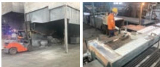
アルミニウムスクラップを再溶解し、お客様のニーズに合わせて最適な成分に調整します。その後、精錬・鋳造工程を経てアルミニウム再生地金へと生まれ変わります。合金事業では、インゴット(地金)による製品提供の他、再溶解を必要としない溶湯供給、また水平リサイクル事業(Can to Can等)など、環境に配慮した製品づくりを行っています。
