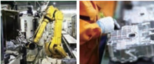
グループ内で製造されたアルミニウム再生地金・溶湯を使用し、四輪を中心としたダイカスト部品を casting・加工・組立しています。量産性と高品質のダイカスト製品は、利用範囲が広く、自動車、二輪自動車、産業機械、医療機械、日用品など様々な用途に利用されています。
