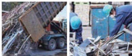
一度使命を終えた製品から出る金属スクラップ。世界中に張り巡らされたネットワークで集荷し、様々な金属が混在するスクラップを高度な選別技術であらゆる金属に仕分け、グループ内外に供給しています。限りある資源をリサイクル原料として社会へ還元することで、循環型社会に貢献しています。
