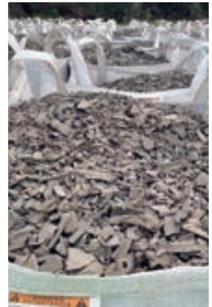
写真⑦大、中、小にサイズ分けされフレコンバック詰めされたZorba
